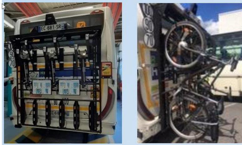
Système de rack à vélos vertical mis en place en 2021 Source : Kéolis Oise
